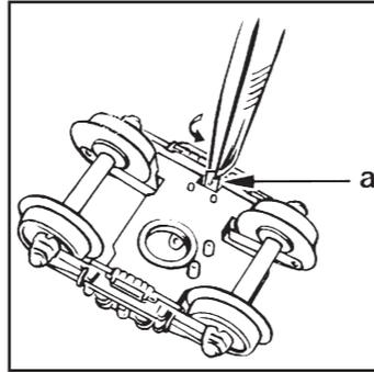
Zur zusätzlichen, endgültigen Fixierung die Nase a auf der Unterseite des Drehgestells mit einer Pinzette nach unten ziehen und leicht verdrehen.
