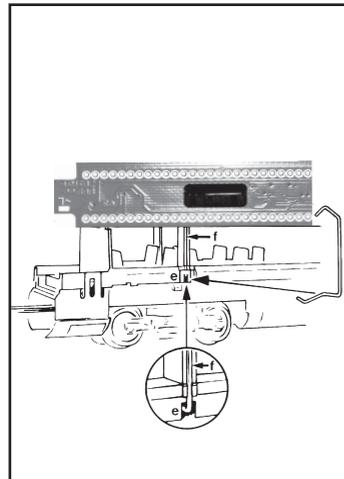
Den Kontaktbügel unten lose einführen, oben über die Kante der Leiterplatte einhängen und abschließend am Punkt **e** fest einrasten. Der Kontaktbügel muss im Schlitz **f** liegen. Insgesamt müssen 4 Kontaktbügel (bei Wagen mit elektronischer Zugschlussbeleuchtung nur 2) montiert werden.
