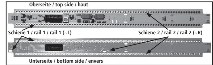
Wenn die Leiterplatte nicht über die Kontaktbügel angeschlossen werden kann, besteht auch die Möglichkeit sie mit Litzen an den Lötstellen anzuschließen.
