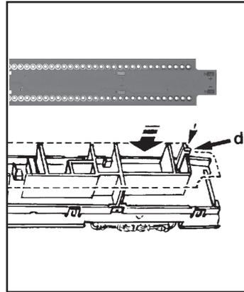
Leiterplatte so auf die Inneneinrichtung legen, dass der Zapfen **d** der Inneneinrichtung in der entsprechenden Ecke der Leiterplatte liegt. Die LED's zeigen nach unten ins Wageninnere. Mit einem Streifen Klebeband am Wagenboden provisorisch fixieren.
