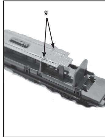
Es wird empfohlen, die Kontaktbügel auf der Leiterplatte zu verlöten **g**, um eine sichere und unterbrechungsfreie Kontaktierung zu gewährleisten.
