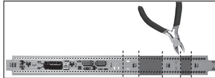
Wird die Leiterplatte in kürzere Wagen eingebaut, muss sie an den vorgesehenen Stellen gekürzt werden. Mit einem Seitenschneider oder einer Schere schneidet man die Leiterplatte auf die benötigte Länge. Der Einbau erfolgt auf die im Folgenden beschriebene Weise.
